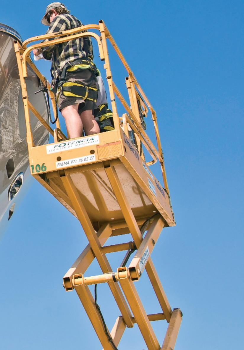
*Para determinados trabajos se utilizan plataformas elevadoras que garantizan seguridad laboral. / Hydraulic cranes guaranteeing workplace safety are used for certain jobs.*
