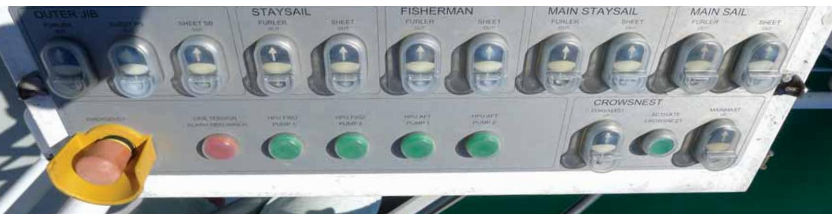
Las velas se controlan desde cubierta a través de esta consola. / The sails are controlled from the deck via this console.
