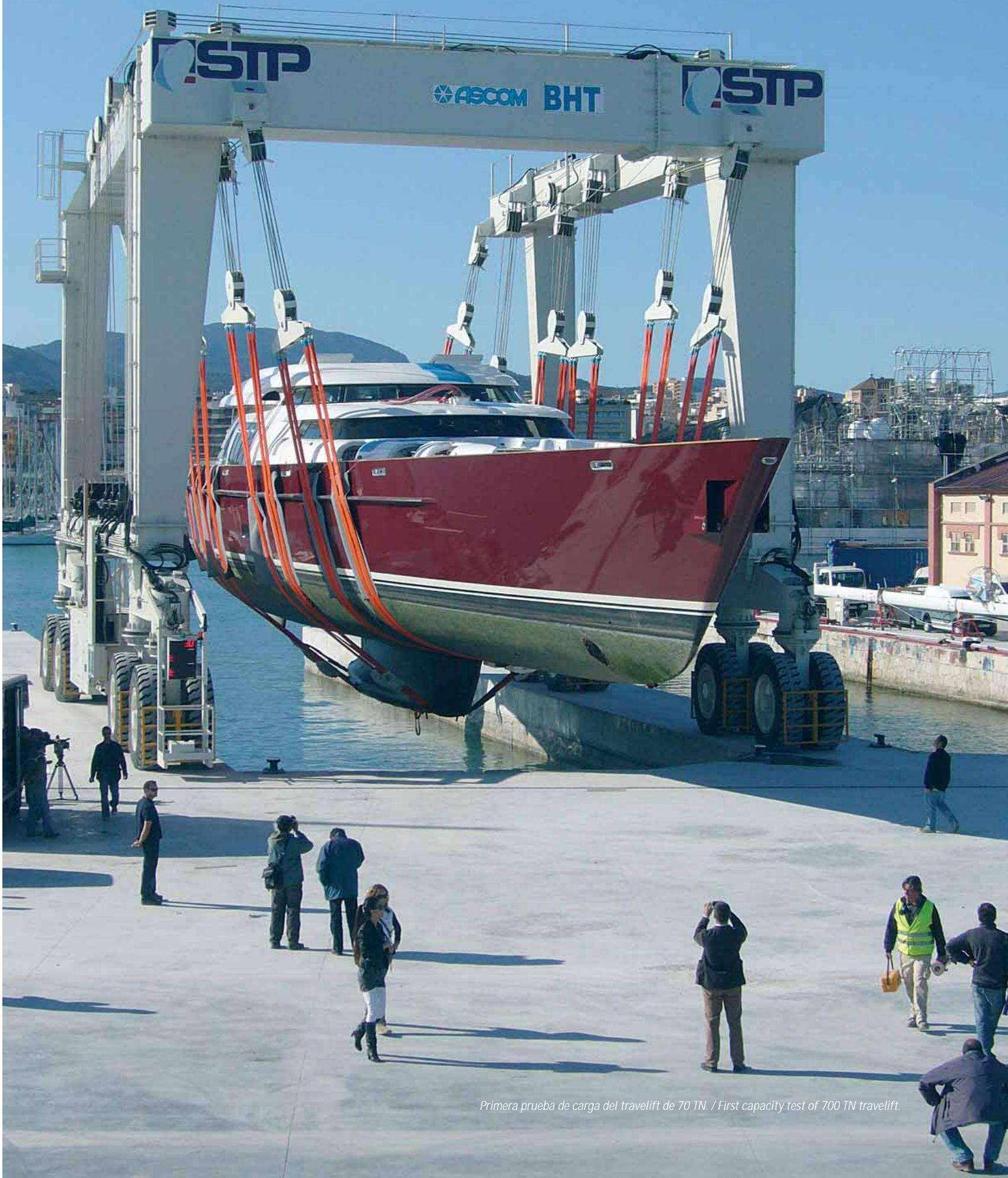
Primera prueba de carga del travelift de 70 TN. / First capacity test of 700 TN travellift.
